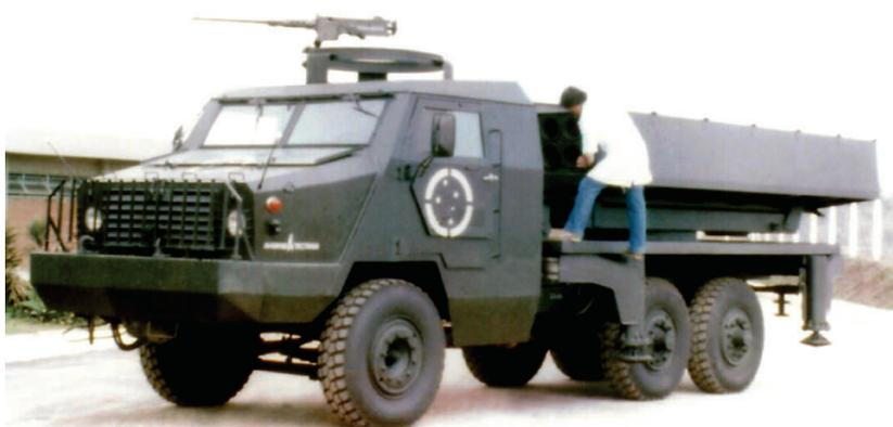
Protótipo do veículo lançador ASTROS I T-0 Brucutu desenvolvido pela Avibrás Aeroespacial S/A em 1982, sobre chassi Mercedes-Benz modelo L-2013 6x2 de fabricação nacional (Foto: Avibrás)
