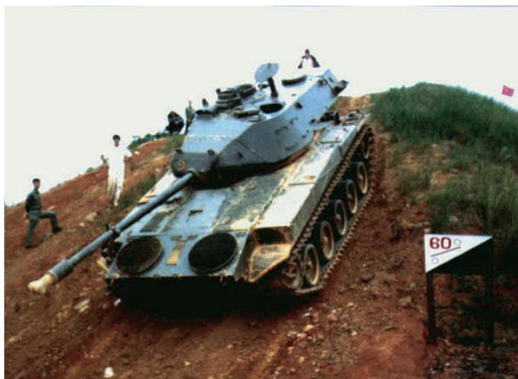
M-41 com o kit da Bernardini sendo testado em Taiwan. Notar as entradas de ventilação do motor redondas
