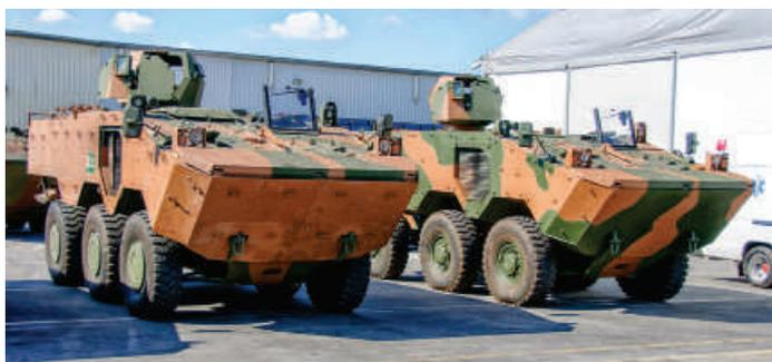
Dois VBTP Guarani 6x6 com a torre MR550 Alan Platt para metralhadora. Notar que o veículo da esquerda possui o kit de blindagem adicional e o da direita não
