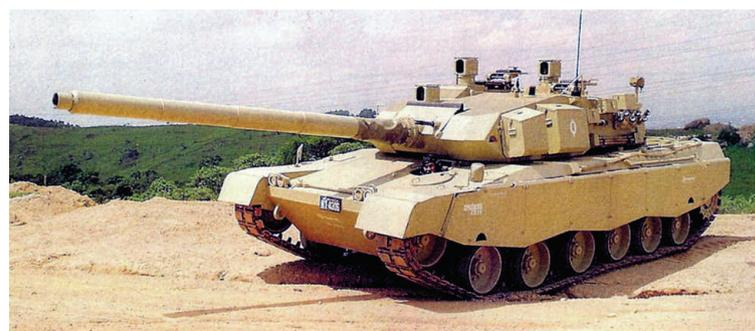
Engesa EE-T1 Osório P2, canhão 120mm, em testes realizados pela Engesa-SP (Foto: Coleção Autor)
