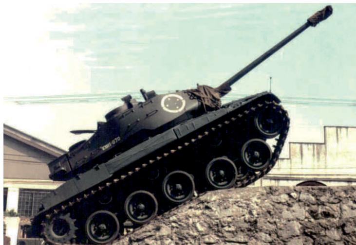
Teste de rampa do M-41 com motor Scania DS14 no PqRMM/2
