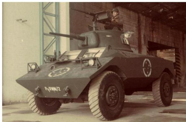
A V.B.B. 1 com quatro pneus P.P.B. (à prova de balas), desenvolvido pela Novatração Ltda. (Crédito da foto: arquivo do autor)
