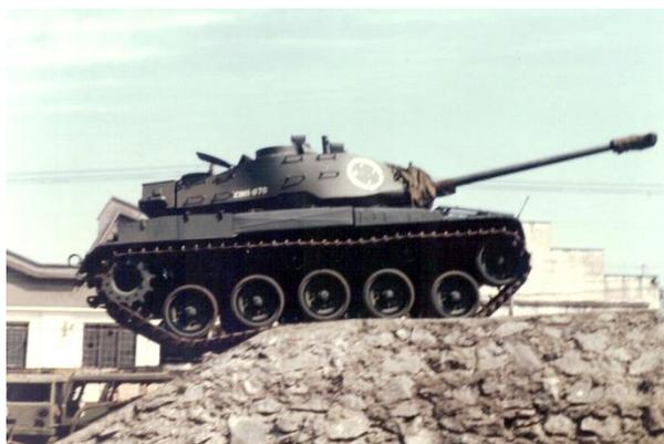
Carro de Combate M-41 com motor diesel Scania em teste de rampa no PqRMM/2 em 1978. (Crédito da foto: arquivo do autor)
