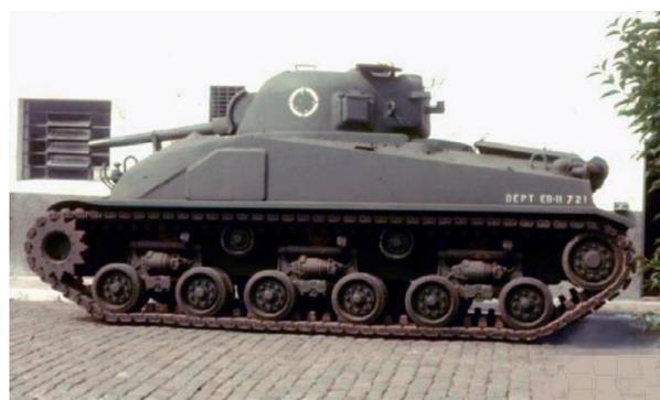
Versão final do Sherman M-4 após instalação de nova suspensão HVSS (Horizontal Volute Spring Suspension). (Crédito da foto: arquivo do autor)
