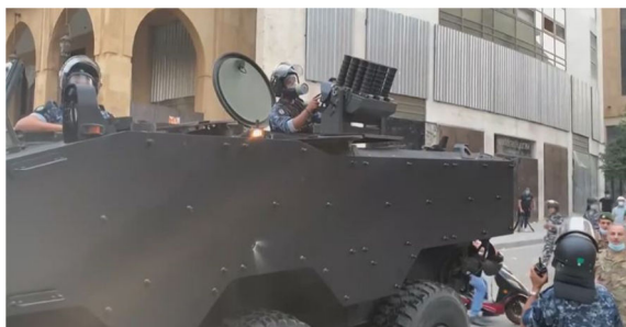
O lançador Cougar 12 instalado sobre o blindado Guarani, na escotilha do comandante, atrás da do motorista. (Foto: MTV)
