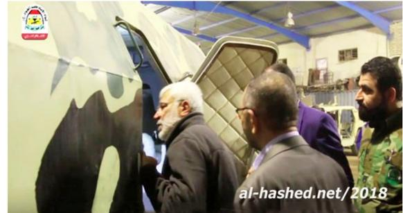
No detalhe da porta é possível ver que seu interior foi totalmente forrado com placas tipo aramida, revestidos com material tipo kevlar, bem flexível, que protege a tripulação contra impactos internos e estilhaçamento. (Crédito da foto: al-hashed.net/2018)
