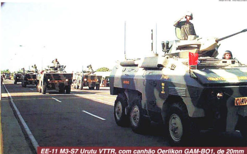
EE-11 M3-S7 Urutu VTTR, com canhão Oerlikon GAM-BO1, de 20mm
