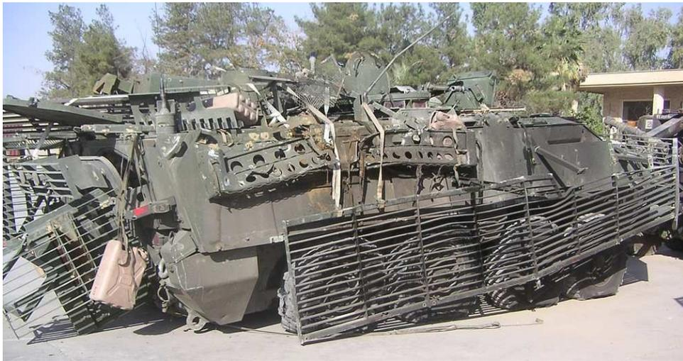
El carro tiene protección NBQ y es muy probable la adaptación de un sistema móvil de detección contra francotiradores, así como de otro sistema (ya adaptado) contra granadas propulsadas por cohetes.
