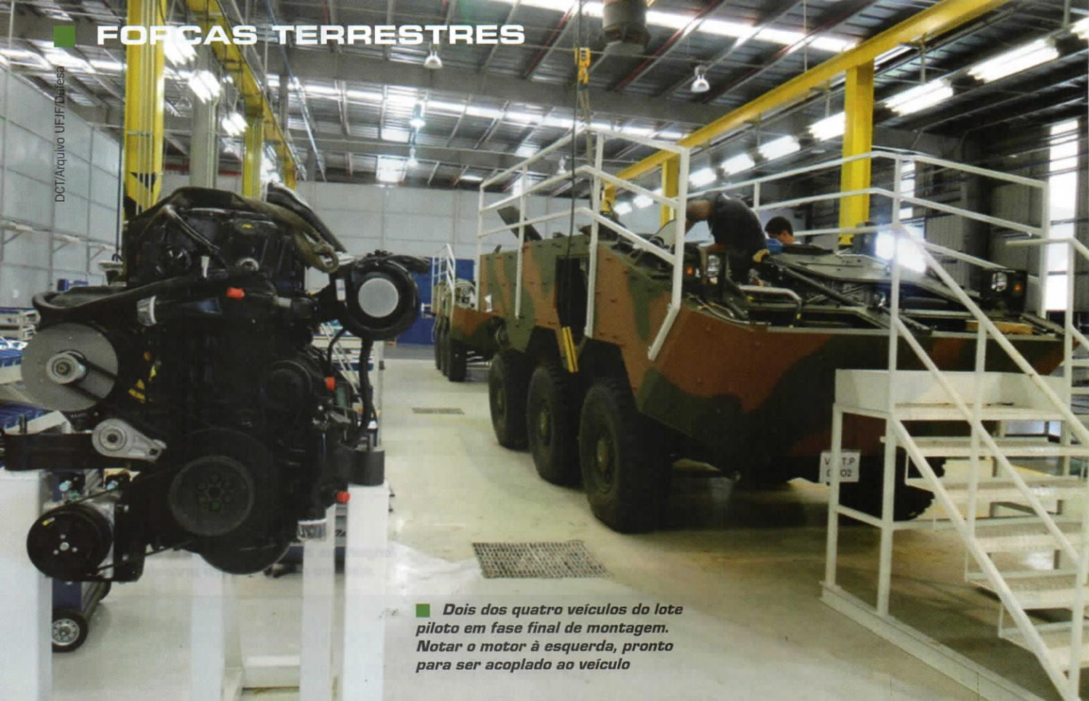
■ *Dois dos quatro veículos do lote piloto em fase final de montagem. Notar o motor à esquerda, pronto para ser acoplado ao veículo*
