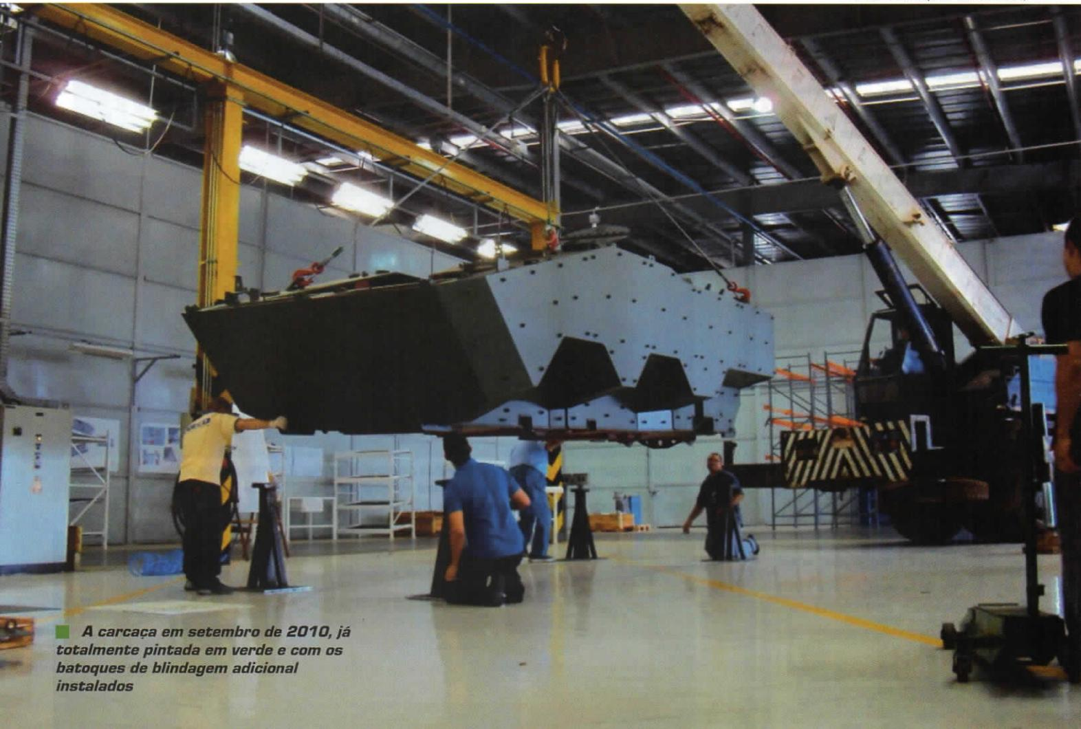
■ A carcaça em setembro de 2010, já totalmente pintada em verde e com os batoques de blindagem adicional instalados
