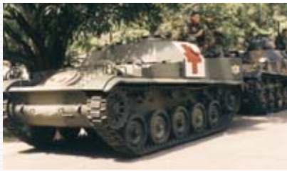
AMX-13 VTT/TB : Vehículo de evacuación sanitaria (ambulancia), desarmado.
