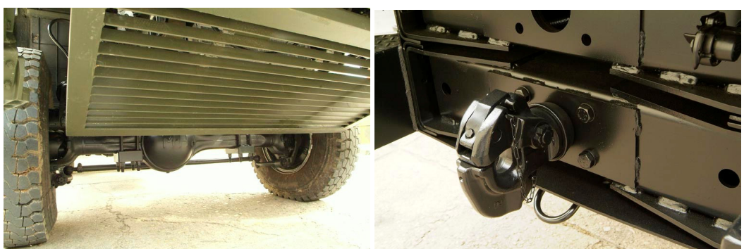
Detalhe da grade de proteção do motor na parte frontal, debaixo do veículo e do engate traseiro que permite tracionar um reboque. (Fotos: Volkswagen Caminhões e Ônibus)
