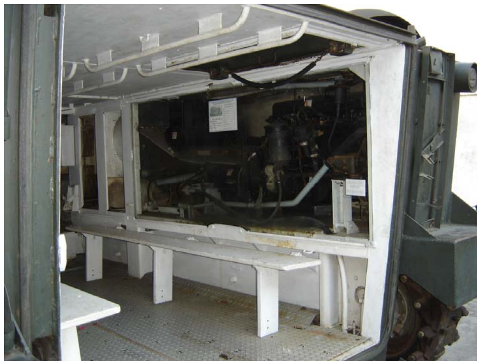
Detalhe interno do M-59 com os painéis de vidro, possibilitando ver todos os detalhes do mecanismo interno. Notar a grande área onde após fechar os bancos levava um Jeep. (foto autor)
