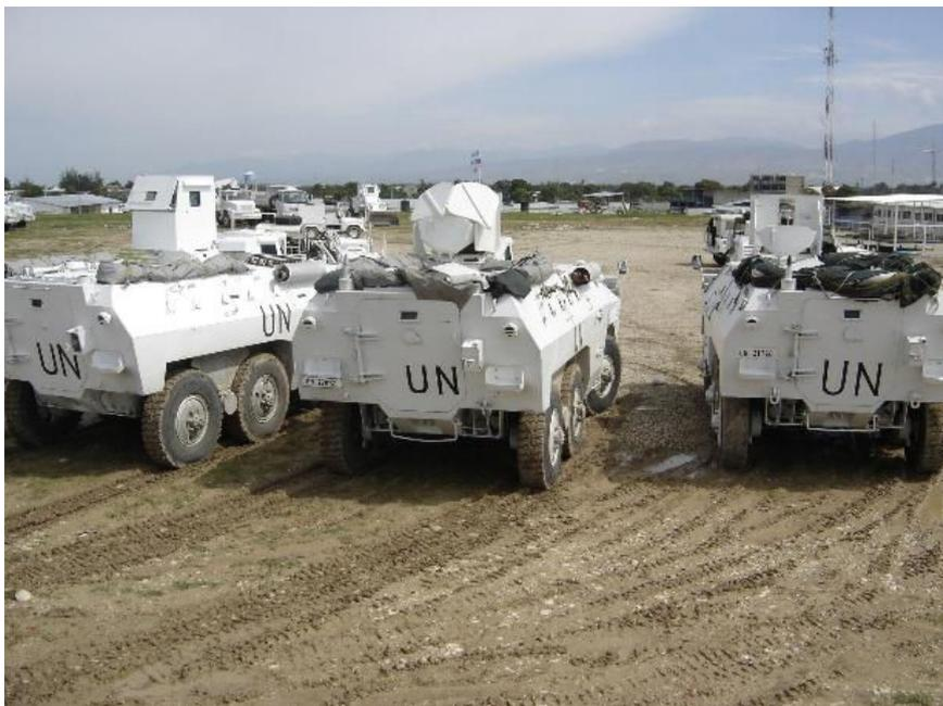
**Detalhe das três torretas usadas nos EE-11 Urutu do Exército. Da esquerda para a direita, torreta fechada blindada fabricada no Arsenal de Guerra de São Paulo; no centro, torreta fabricada no Haiti e com as duas tampas de escotilhas soldadas na traseira e a direita a mesma sem as escotilhas soldadas, ainda no original como foi construída localmente. Os três tipos estão em operação. (Foto: autor 03/junho/2008)**
