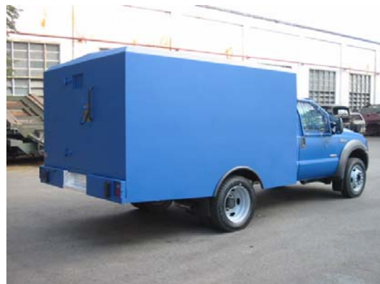
Versão TRANSPORTE DE PRESOS blindada 4x4 sobre chassi Ford-550. (Foto: Centigon Ltda – coleção autor)
