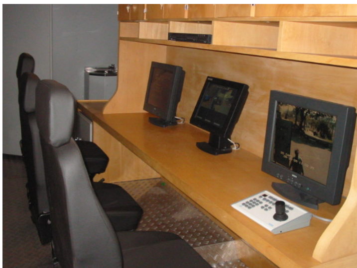
Detalhe do interior do veículo COMANDO E CONTROLE. Notar os monitores LCD e a manete de aproximação da câmera panorâmica de 360°. (Foto Centigon Ltda – Coleção autor)
