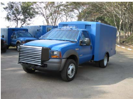
Versão TRANSPORTE DE PRESOS blindada 4x4 sobre chassi Ford-550. (Foto: Centigon Ltda – coleção autor)
