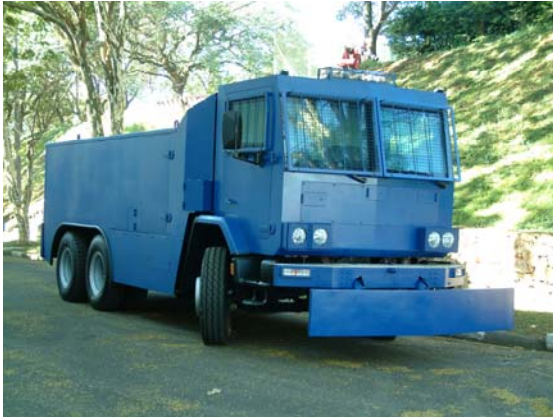
Veículo blindado canhão de água. Notar a lâmina frontal para remoção de obstáculos. (Foto: Centigon Ltda – Coleção autor)
