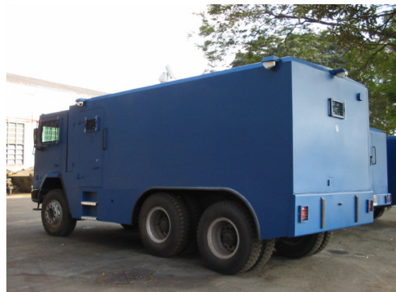
Veículo COMANDO E CONTROLE equipado com câmeras ao seu redor, imagem real em tempo real. (Foto: Centigon Ltda – Coleção autor)
