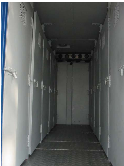
Detalhe do interior do veículo blindado TRANSPORTE DE PRESOS. Notar as celas individuais. (Foto: Centigon Ltda – Coleção autor)
