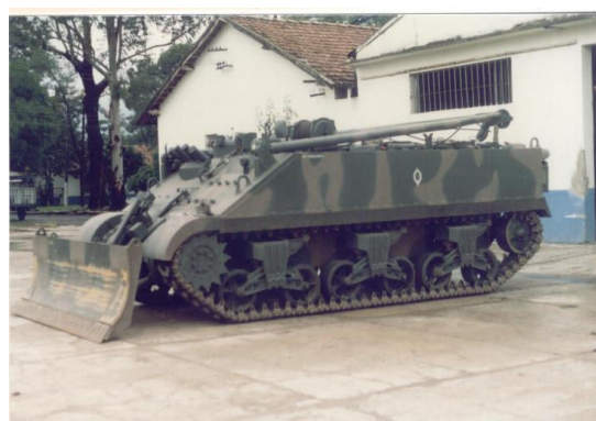
VBE-ENG-M4-30t Lag. Notar a lâmina de terraplanagem na parte frontal. (Fotos: autor)
