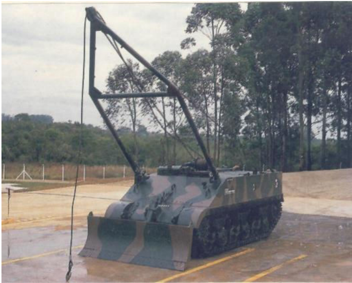
O VBE-ENG-M4-30t Lag, com sua lança articulada na posição para tracionar cargas de até 10t e no desenho o equipamento caça-minas. (Fotos: Coleção autor)
