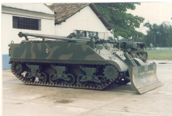
VBE-ENG-M4-30t Lag. Notar a lâmina de terraplanagem na parte frontal. (Fotos: autor)
