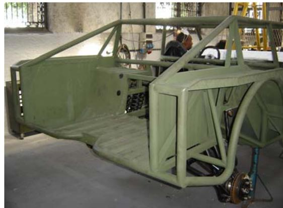
**Detalhes da suspensão dianteira e do compartimento traseiro onde ficará o pneu estepe em pé e o espaço para cargas diversas. (Fotos: autor)**
