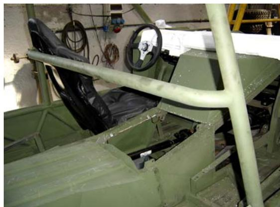
**Motor MWM diesel e detalhe da parte interna do veículo que em função de sua baixa silhueta teve o motor e caixa de transmissão recuada para o interior do veículo, ficando entre o motorista e o chefe do carro. O interior, guardadas as devidas proporções, lembra em muito o do Humvee americano. (Fotos: autor)**
