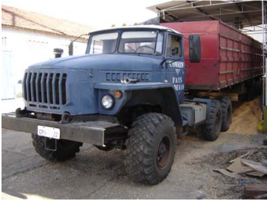
A versão transformada pela Aeronáutica para rebocar carreta de 40 toneladas de carga. Notar a pintura e marcações padrão da FAB. (Crédito das fotos: autor)
