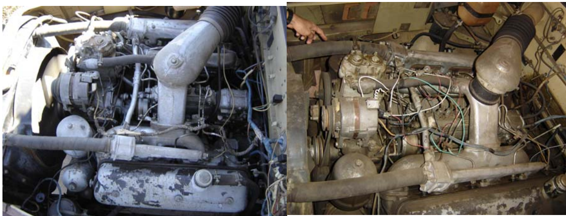
À esquerda motor V-8 e à direita V-6, respectivamente versão 6x6 e 4x4. (Crédito das fotos: autor).
