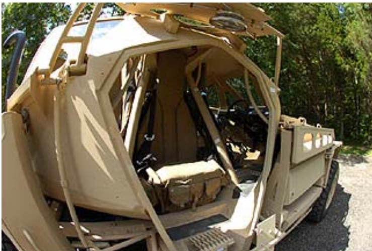
Detalhe do interior da cabine blindada. Notar a posição em que ficam os quatro tripulantes. No diagrama ao lado. (Crédito das fotos: Georgia Tech Research Institute - GTRI)
