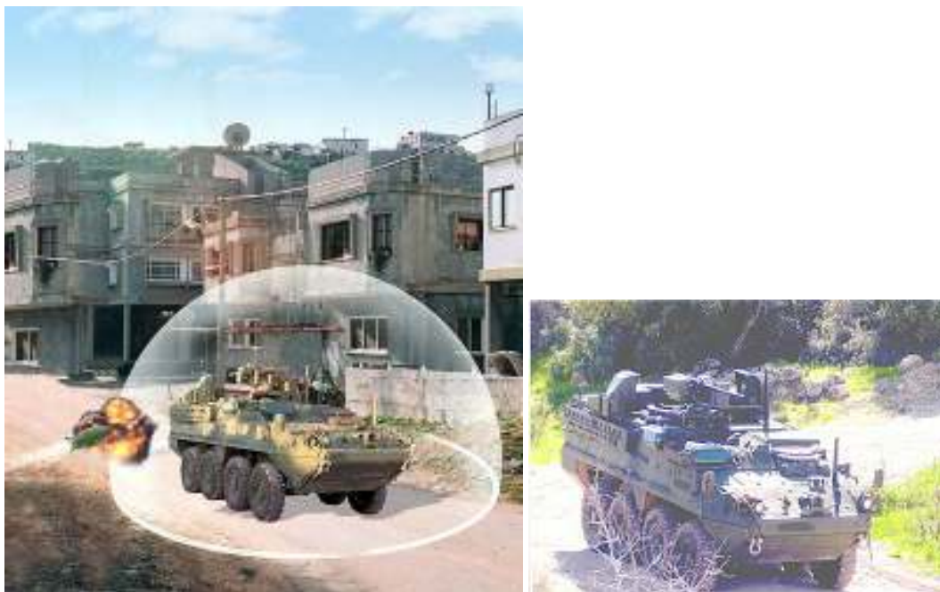
Concepção artística de como o “Trophy” protege o veículo blindado Stryker, criando um espécie de “bolha” sobre o veículo e destruindo o míssil anticarro com submunições, e Stryker em testes nos Estados Unidos com dois sistemas “Trophy” sobre o veículo na parte traseira. (Ilustração: Rafael e General Dynamics)
