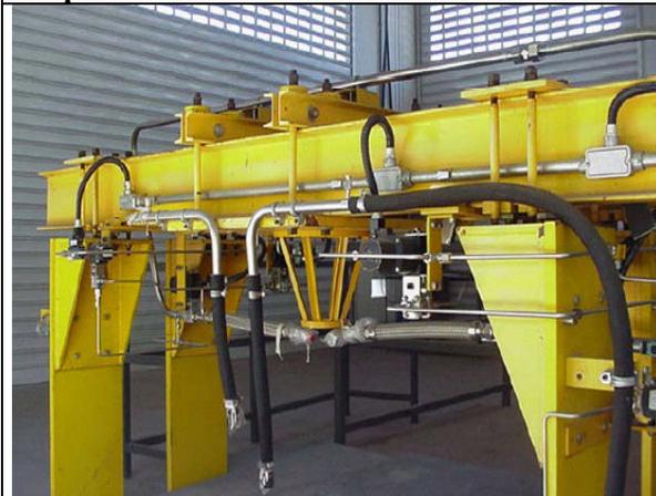
**Banco de Provas para motores-foguete à propulsão líquida de até 20kN de empuxo-IAE**
