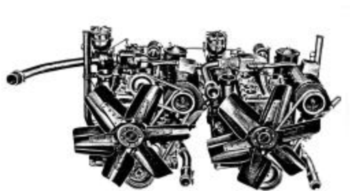
Vista frontal dos dois motores Hércules JXD. Eles eram acoplados lado a lado. Foto: U.S.Army
