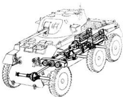
Detalhes do posicionamento dos dois motores Hércules JXD e seu sistema de transmissões. Foto: U.S.Army
