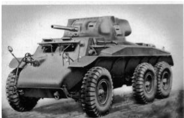
T-17 Deerhound. Notar a vulnerabilidade de seu casco. Foto: U.S.Army
