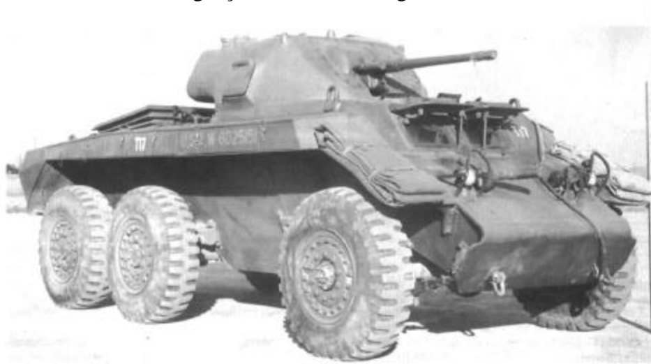
Vista lateral do T-17. Notar a porta de acesso ao seu interior atrás da roda dianteira. Foto: U.S.Army
