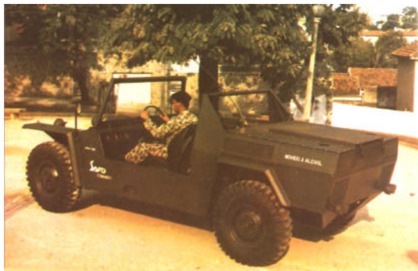
O SAFO-COMANDO visto de trás, notar o tamanho do compartimento do motor e inscrição "Movido a Álcool". (Crédito da foto: JAMY)
