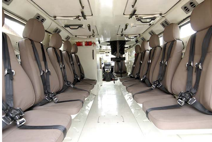
Detalhe do interior do RG-35 na versão transporte de tropas. (Foto: BAE Systems)
