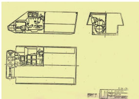
Versões prevista para o veículo na classe de 3 toneladas. Torre com canhão de 20mm, lançador de mísseis TOW Anticarro e versão metralhadora 7,62mm e detalhe da disposição do motor. Notar que possui quatro rodas de apoio. (Coleção do autor)
