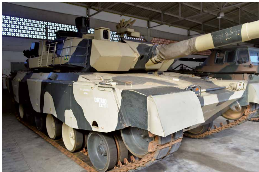
Inne ujęcie prototypu P2. Na stropie jego wieży widoczne celowniki VS580. Urządzenie celownicze zamontowane niżej znajduje się na stanowisku działonowego, a zamontowane wyżej na stanowisku dowódcy. W tym drugim przypadku jest to celownik panoramiczny.
