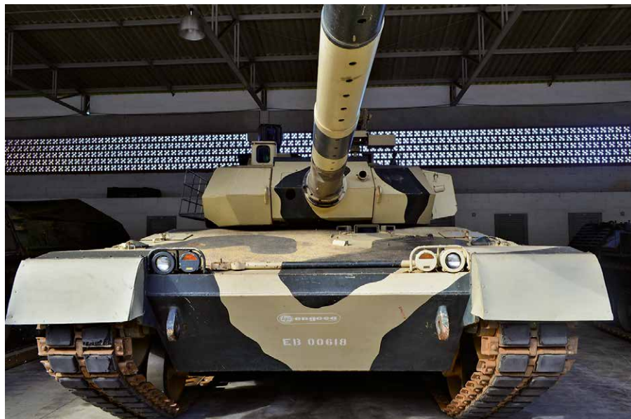
Prototyp Osorio P2 widok z przodu kadłuba. Dobrze widoczne są przód wieży i 3 peryskopy kierowcy, światła przednie, sprzężony z armatą 7,62 mm km oraz stalowe gąsienice łącznikowe pochodzące z niemieckiej firmy Diehl.
