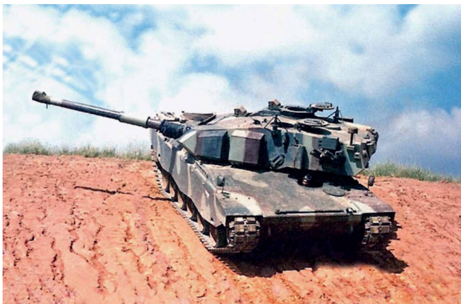
Ten sam prototyp P1 z wieżą obróconą w stronę prawej burty kadłuba. Widoczny otwarty na lewą stronę właz stanowiska kierowcy. Dzięki widocznemu na lufie armaty L7 przedmuchiawcowi prototyp P1 łatwo jest odróżnić od P2 z armatą 120 mm.
