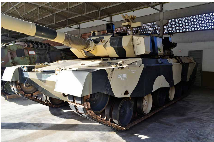
Prototyp Osorio wersji P2 uzbrojony w gładkolufową, pochodzącą z Francji armatę G1 kalibru 120 mm. Dobrze widać koła napinające układu jezdnego. Obok tegoż czołgu wyraźnie widoczny jest wóz zabezpieczenia technicznego na bazie Leoparda 1 .
