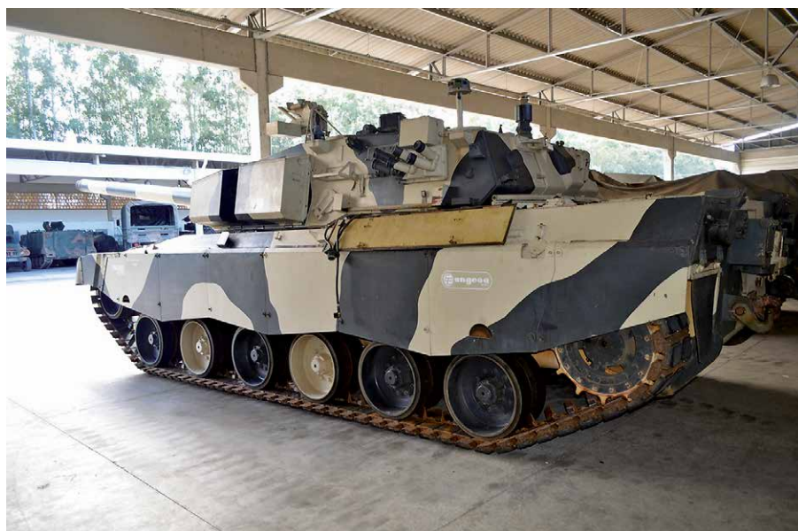
Osorio P2 – widok z lewej strony. Na stropie wieży można zauważyć detektory systemu ostrzegającego przed laserowymi pomiarami odległości, a na jej boku widoczne są również wyrzutnie wybuchowych granatów dymnych kalibru 66 mm.
