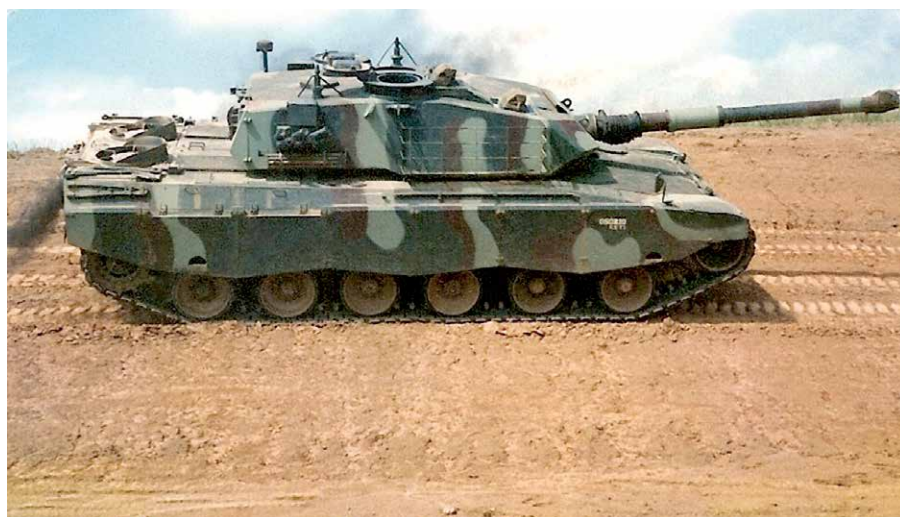
Uzbrojony w armatę L7 kalibru 105 mm prototyp Osorio wersji P1. W jego przypadku na boku jego wieży widać 6 wyrzutni granatów. Natomiast na tylnej części stropu kadłuba dobrze widoczne są wentylatory układu chłodzenia.
