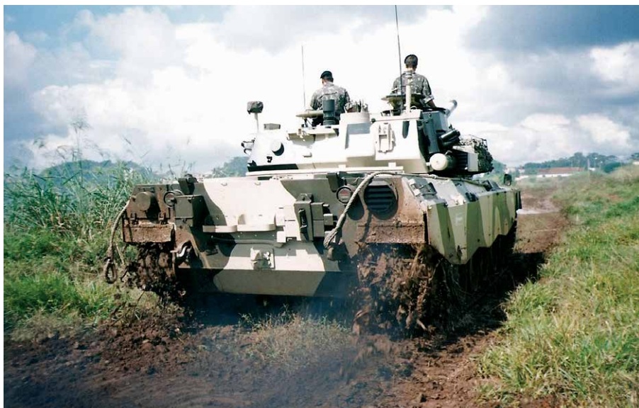
Osorio P2 podczas jazdy poza drogami o utwardzonej nawierzchni. Dobrze widoczne są między innymi oświetlenie tylne, liny oraz inne szczegóły charakterystyczne dla tyłu kadłuba czołgu wersji z armatą kalibru 120 mm.
