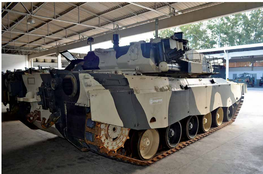
Osorio P2 widoczny od tyłu kadłuba i wieży. Dobrze widać koła nośne czołgu i prawe koło napędowe, a także wielosegmentowe osłony prawej górnej gałęzi gąsienicy układu jezdnego.
