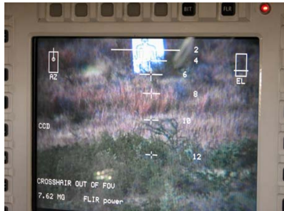
Vista do interior do veículo. Notar o computador e tela de cristal líquido e a imagem diurna do alvo a ser atingido pelos tiros da metralhadora. (fotos Sgt. Presoto e Cap. Lyzandro)
