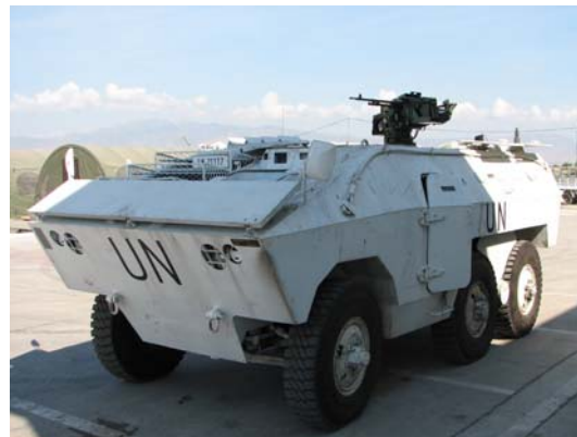
EE-11 URUTU com a torreta RCWS 30 no Haiti com metralhadora .50 à esquerda e MAG 7y.62mm à direita. (fotos Sgt. Presoto e Cap. Lyzandro)
