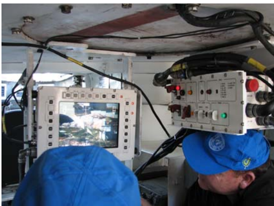
Vista do interior do veículo. Notar o computador e tela de cristal líquido e a imagem diurna do alvo a ser atingido pelos tiros da metralhadora. (fotos Sgt. Presoto e Cap. Lyzandro)
