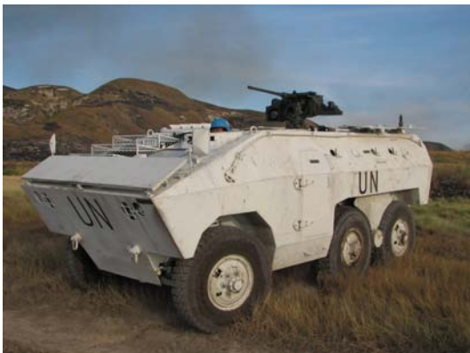
EE-11 URUTU com a torreta RCWS 30 no Haiti com metralhadora .50 à esquerda e MAG 7y.62mm à direita. (fotos Sgt. Presoto e Cap. Lyzandro)
