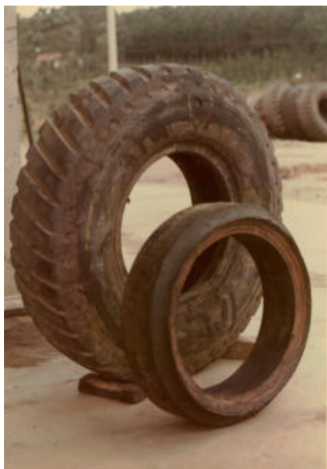
Pneu P.P.B. com o anel de borracha, testado em diversos veículos, à esquerda. À direita pneu 11.00-20, após a modificação do desenho feito pela Novatração, similar ao da OTAN. Crédito das fotos: Coleção do autor
