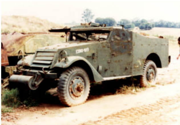
Sucata de M-3 Scout Car com pneus P.P.B. fotografados em outubro de 1987 e pneus P.P.B. com o anel de borracha testado em diversos veículos, sem câmara. À direita Half-Track M-2 com pneus P.P.B. com câmara, na sua primeira versão. Crédito das fotos: Coleção do autor.
