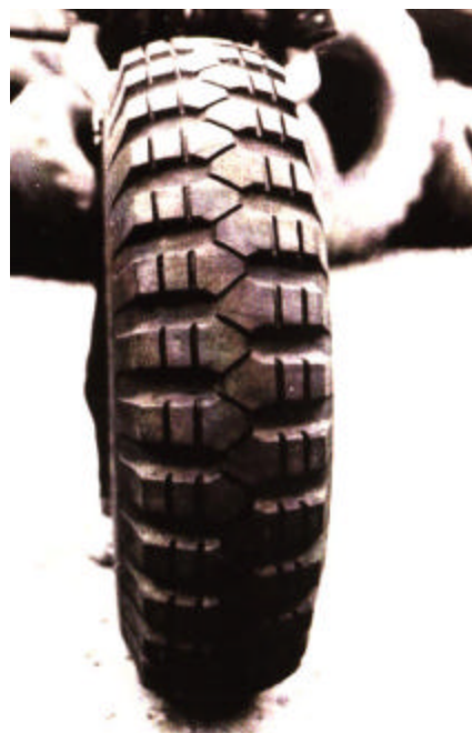
Pneu P.P.B. com o anel de borracha, testado em diversos veículos, à esquerda. À direita pneu 11.00-20, após a modificação do desenho feito pela Novatração, similar ao da OTAN. Crédito das fotos: Coleção do autor
