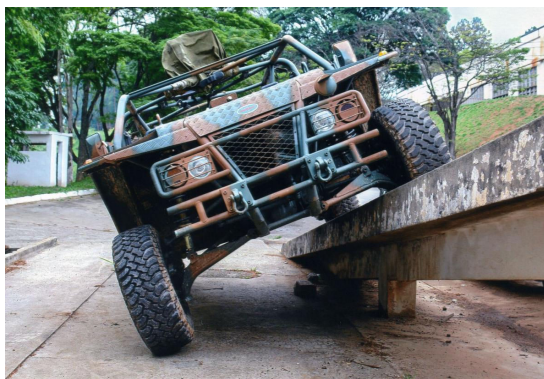
Chivunk 4x4 sendo testado em São Paulo, notar o sistema de suspensão independente. (Fotos: Coleção autor)
