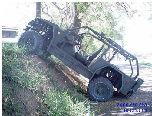
Chivunk 4x4 sendo testado em São Paulo, notar o sistema de suspensão independente. (Fotos: Coleção autor)
