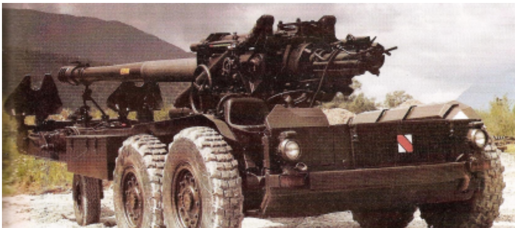
Obuseiro GHN-45 de 155mm com unidade de autopropulsão própria. (Foto: Noricum)
