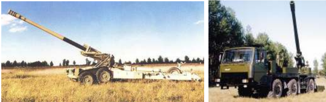
W88, versão Chinesa baseada no obuseiro GHN-45 produzido pela NORINCO e uma outra variação montada sobre um caminhão. (Fotos: Chinese Internet).
