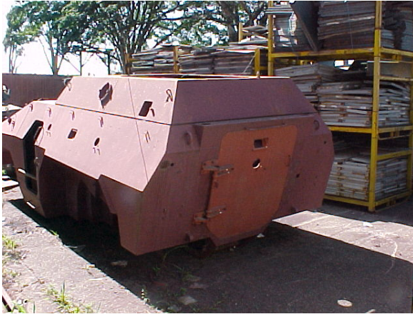
Detalhes da traseira e da estrutura sobre o veículo que aumenta sua altura e componentes como portas e respiro do motor no interior da carcaça. (Crédito das fotos: autor)
