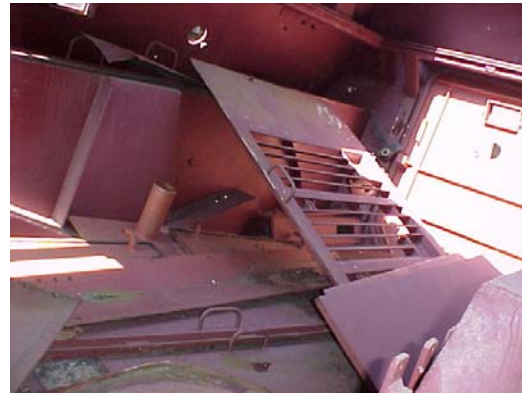
Detalhes da traseira e da estrutura sobre o veículo que aumenta sua altura e componentes como portas e respiro do motor no interior da carcaça. (Crédito das fotos: autor)
