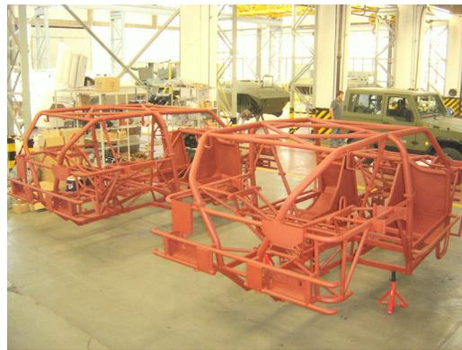
Os dois novos protótipos do CHIVUNK em fase de montagem no AGSP, fotografados em 20 de julho de 2007. Notar a estrutura tubular e os motores dos novos veículos. (Fotos: autor)
