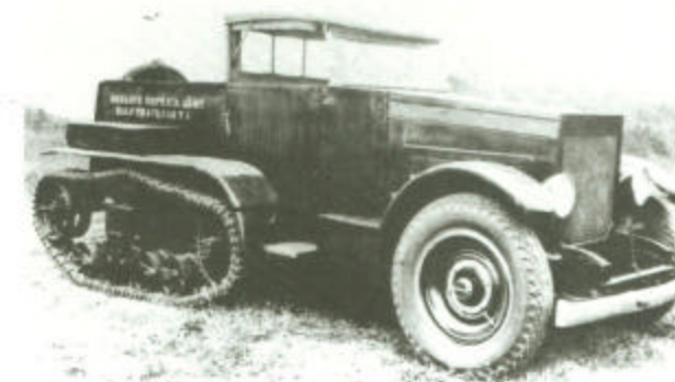
Cunningham T-1 com suspensão traseira do T-1E3, predecessora dos modelos Half-Track do Exército Americano na segunda guerra mundial. (foto:USArmy)
