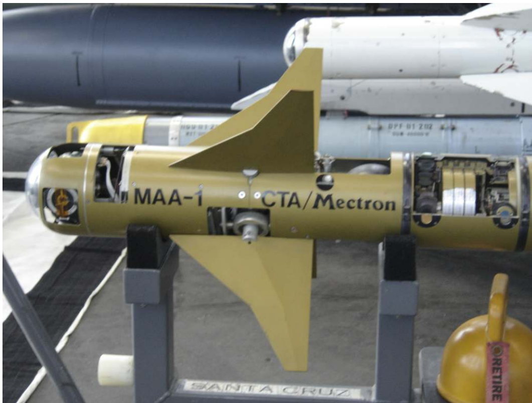
Detalhe da seção de guiagem na cabeça do míssil MAA-1 Piranha, em corte. (Foto: Roberto Bertazzo)
