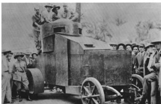
Blindados construídos em Minas Gerais, em Uberaba e Palmyra (atual Santos Dumont). À esquerda sobre um chassi de caminhão inglês Tornycroft e à direita sobre um veículo de passeio Chevrolet. (Fotos: Coleção autor)
