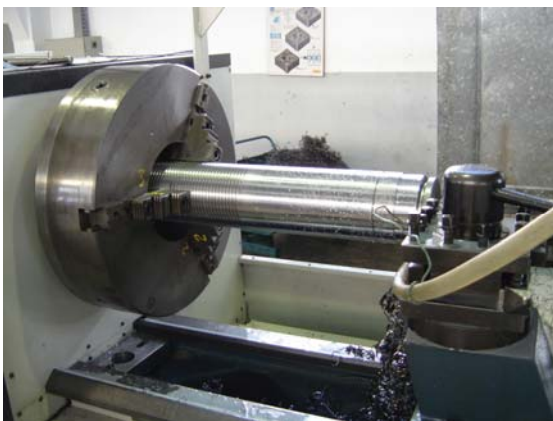
Detalhes da fabricação do cano em algumas de suas etapas. (Fotos: autor)
