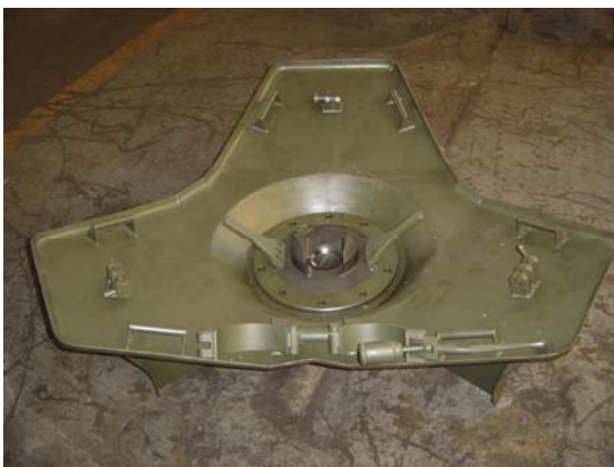
Detalhes da peça “base de giro” pronta e já colocada na placa-base que irá suportar o cano do morteiro. (Fotos: autor)
