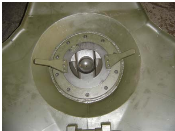
Detalhes da peça “base de giro” pronta e já colocada na placa-base que irá suportar o cano do morteiro. (Fotos: autor)
