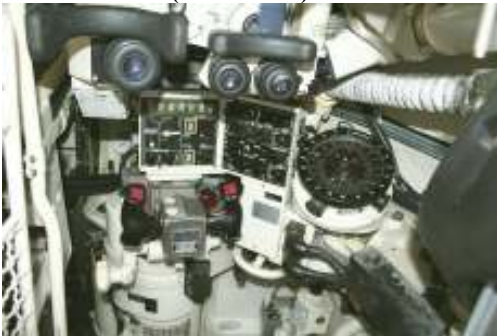
Interior do Leopard 1 A5 da EsMB, notar a instrumentação de tiro no compartimento do comandante do carro. (Foto: autor)
