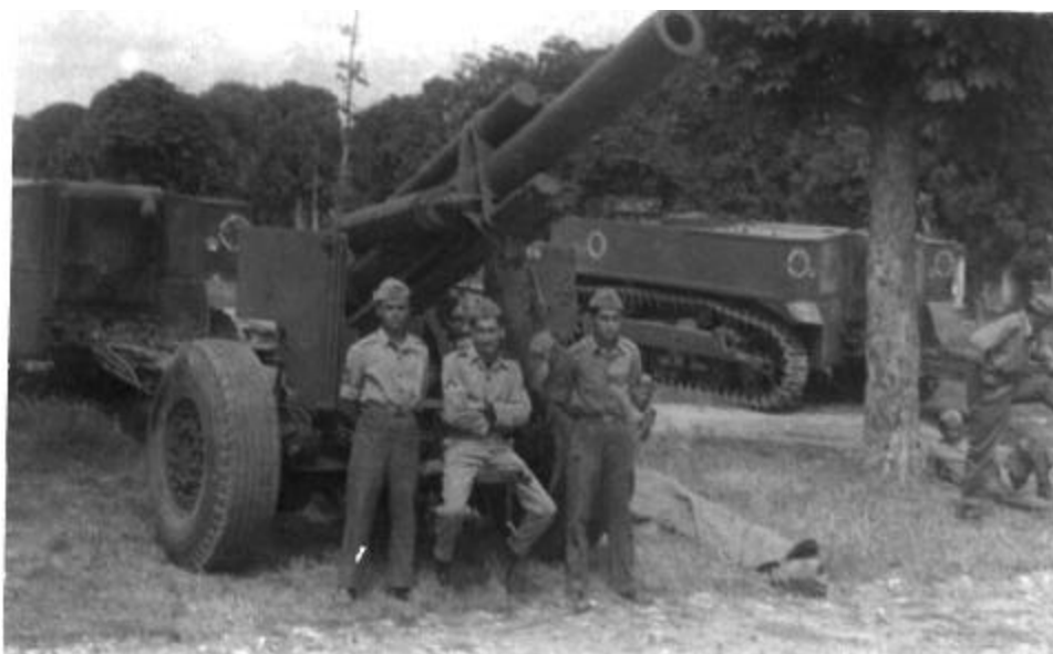
Peça de artilharia de 155mm da 3ª Bateria do IV Grupo do I/1º R.A.P.C. e dois tratores M-5 da FEB. Notar a ausência da capota e as marcações brasileiras nas laterais e traseira dos veículos. Itália 1944/45. (Coleção: Paulo Márcio Leal de Menezes)
