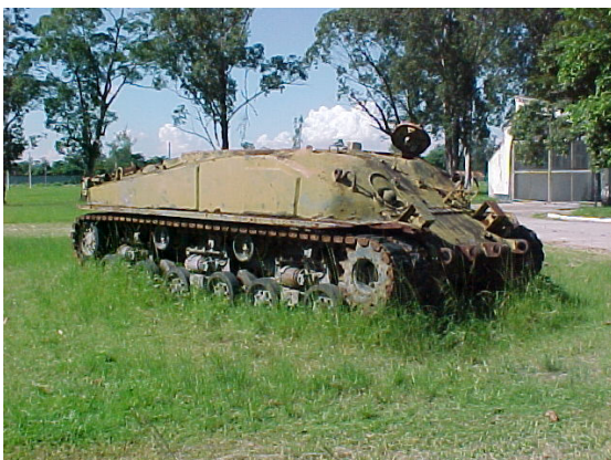
Carcaça do Sherman anti-minas. Notar os engates do rolete na parte frontal do veículo. (Fotos: autor)
