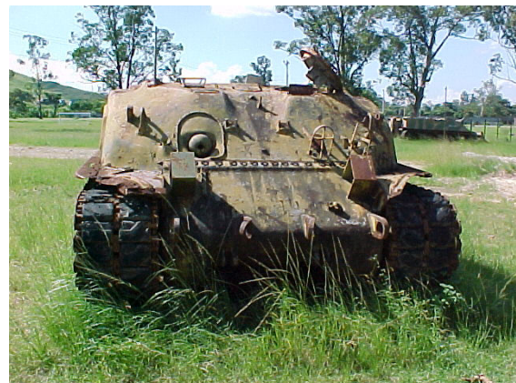
Carcaça do Sherman anti-minas. Notar os engates do rolete na parte frontal do veículo. (Fotos: autor)
