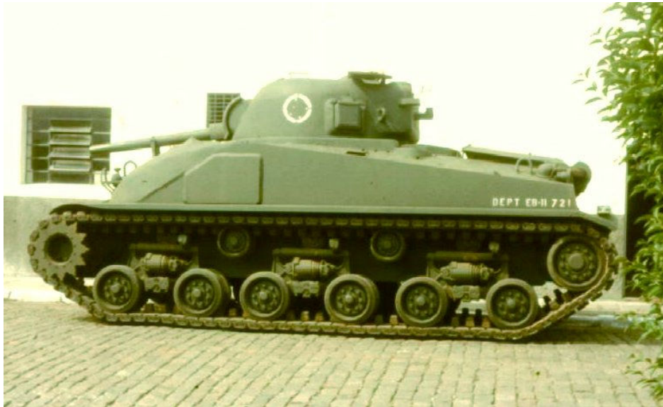
Sherman M-4 Composite Hull já modernizado, com nova suspensão e motor MWM, que serviu de base para o projeto do Sherman anti-minas. (Foto: Coleção autor)
