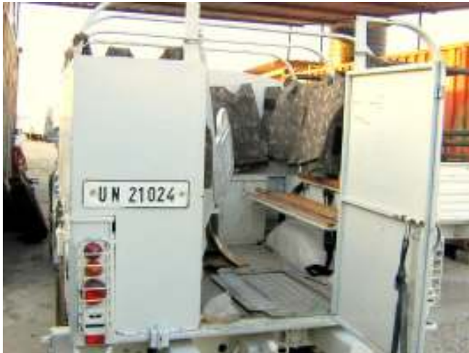
Detalhe do interior traseiro, notar os coletes a prova de balas usados como meio de ampliar a blindagem lateral do veículo. (Foto: Arquivo Cap. Lyzandro)
