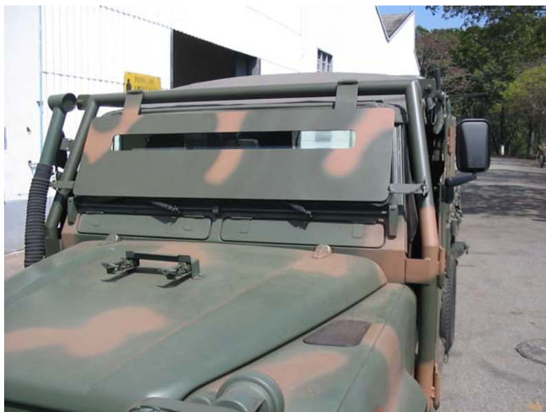
Detalhe da parte frontal do kit de blindagem que será usado pelas tropas brasileiras em suas Land Rover no Haiti. A diferença é que elas estarão pintadas de branco com as marcações UN. (Crédito da foto: Centigon Ltda)
