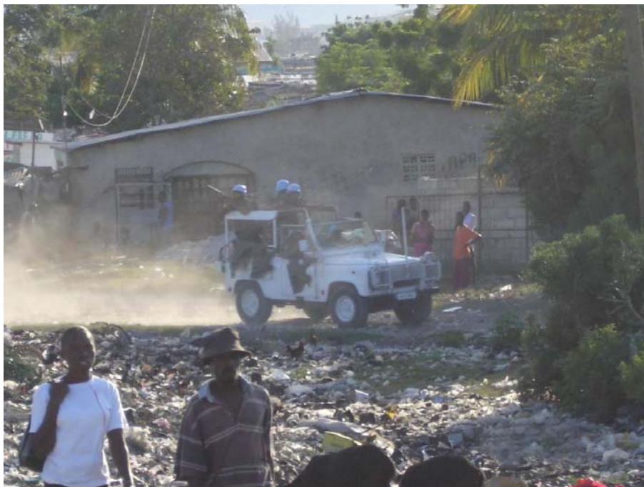
Land Rover 90 do Exército Brasileiro em patrulha no Haiti. Notar os coletes à prova de balas dispostos na lateral como forma de proteção, visto que o veículo não é blindado. (Crédito da foto: CComSEx)
