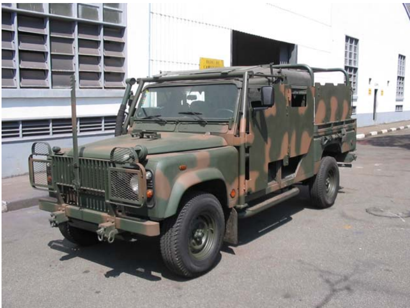
Land Rover do Exército Brasileiro com o kit de blindagem acoplado à viatura. Notar a proteção lateral. (Crédito da foto: Centigon Ltda)
