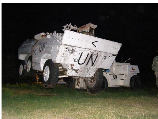
Na seqüência acima e abaixo, a empilhadeira TCM FD-150s se posicionando, levantando, transportando e colocando o EE-11 Urutu sobre a carreta. (Fotos: Sgt. Brandão)
