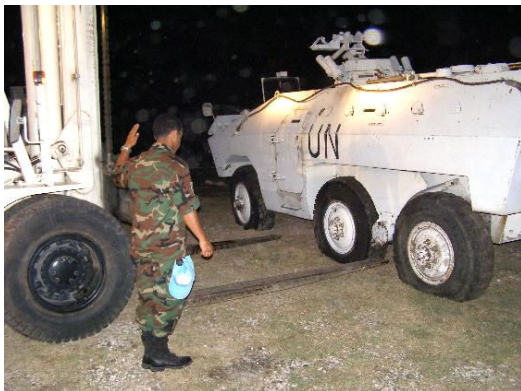
Na seqüência acima e abaixo, a empilhadeira TCM FD-150s se posicionando, levantando, transportando e colocando o EE-11 Urutu sobre a carreta. (Fotos: Sgt. Brandão)
