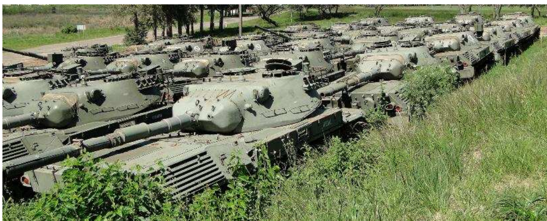
Leopard 1A1 Belgas aguardando para serem desmanchados e partes de suas peças servirão para serem usadas nos 1A5 recém adquiridos, fotografados em 03 de outubro de 2011. (Foto: Autor)
