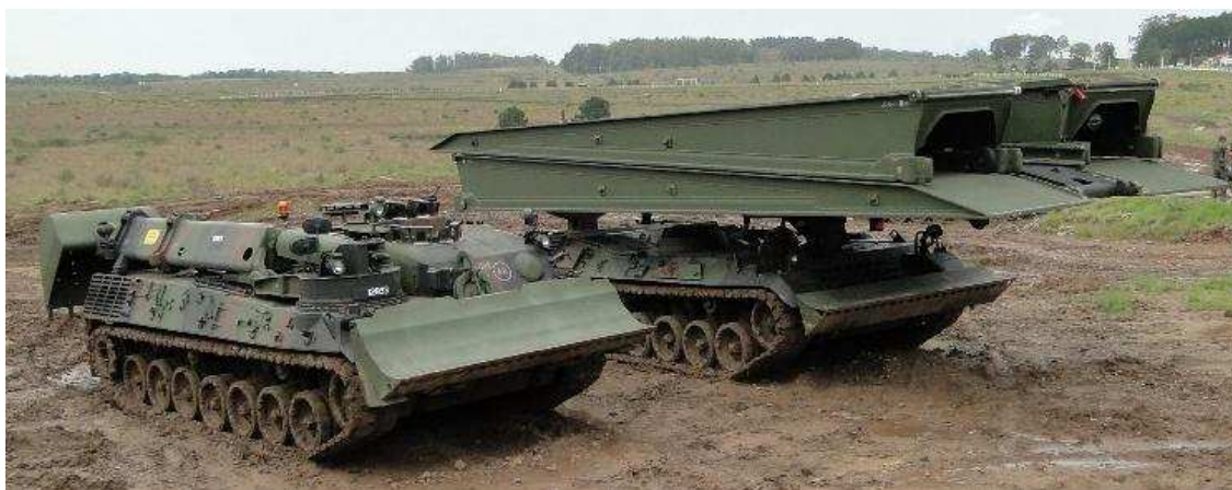
Blindados de apoio Leopard Engenharia e Lança-ponte. (Foto: Autor)
