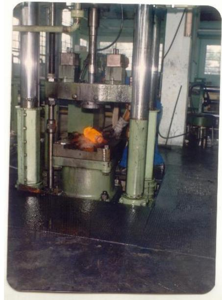
À esquerda forjamento corpo da granada de 105 mm AE MD1, estiramento em prensa hidráulica de 250 toneladas – horizontal. À direita extrusão de granada de 105 mm em prensa hidráulica de 400 toneladas. (Fotos: Arquivo Imbel-JF)
