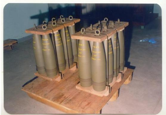
À esquerda, Cintagem da granada de 155 mm AE MD1. Á direita, Pallets de munição 155 AE MD1 e 155 LST MD1 prontas para embarque. (Fotos: Arquivo Imbel-JF)
