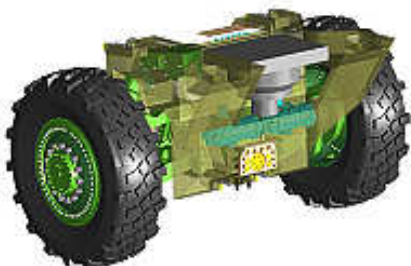
Desenho mostrando o motor elétrico acoplado no eixo do veículo. (Foto: RHEINMETALL LANDYSTEME GmbH)
