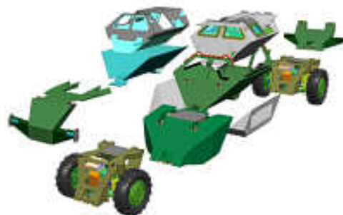
Concepção artística do futuro GeFaS 4x4 e desenho mostrando sua estrutura modular. (Fotos: RHEINMETALL LANDSYSTEME GmbH)
