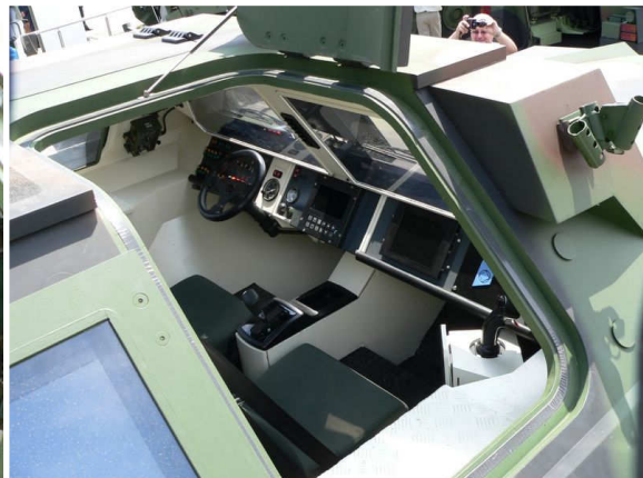
Detalhes do interior do GeFaS apresentado na Eurosatory 2006, à esquerda compartimento traseiro da tropa e à direita detalhes do interior do habitáculo do motorista e chefe do carro. Notar o câmbio automático e os compartimentos para GPS e outros instrumentos. (Fotos: Deagel. Com - http://www.deagel.com/collection/Eurosatory_2006_2.htm )
