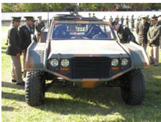
À direita o protótipo um sendo apresentado em abril de 2005 aos Oficiais Argentinos e à esquerda nas manobras realizadas em Córdoba. Notar a versão final da grade frontal, bem diferente das duas que foram apresentadas no início da construção do protótipo. Notar os pára-lamas retos que permitem o empilhamento de dois veículos para facilitar o transporte num avião C-130 ou G-222. (Fotos: Ejército Argentino)
