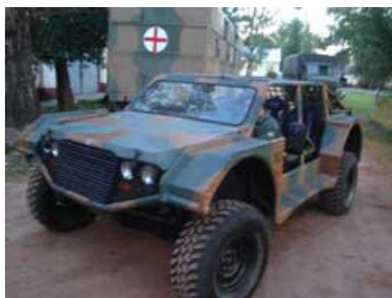
À direita o protótipo um sendo apresentado em abril de 2005 aos Oficiais Argentinos e à esquerda nas manobras realizadas em Córdoba. Notar a versão final da grade frontal, bem diferente das duas que foram apresentadas no início da construção do protótipo. Notar os pára-lamas retos que permitem o empilhamento de dois veículos para facilitar o transporte num avião C-130 ou G-222. (Fotos: Ejército Argentino)
