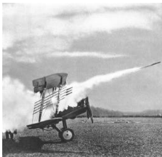
Foguetes de cauda usados em avião francês da 1ª Guerra, contra balões de observação, de barragem e dirigíveis.
