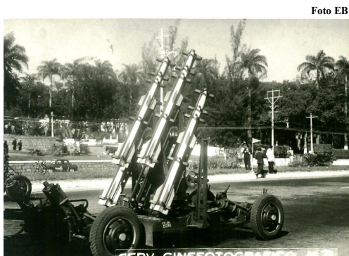
Lançadores de foguetes F-114-DE com cinco foguetes, montados sobre reparos Bofors 40/60. Notar o lançamento de um foguete Fv-108-R na foto da direita.
