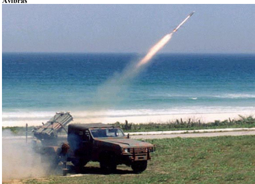
Sistema Astros Hawk montado sobre um veículo Tectran ¾ ton modelo TT-1000, 4x4 e AV-SS 12/36 auto-rebocado. Ambos utilizam os foguetes Skyfire 70.
