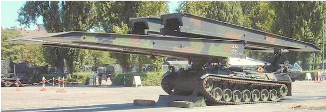
Leopardo BIBER – lança ponte, com capacidade de superar obstáculos de até vinte metros de largura, transportado em duas metades de onze metros cada, similar aos quatro adquiridos pelo Exército Brasileiro. (Foto: http://www.primeportal.net/apc/leopards.htm )
