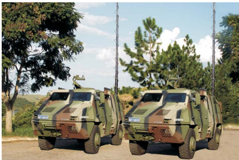
Dois Veículos blindados AV-VBL na versão posto meteorológico do Exército da Malásia, na fábrica da Tectran.
