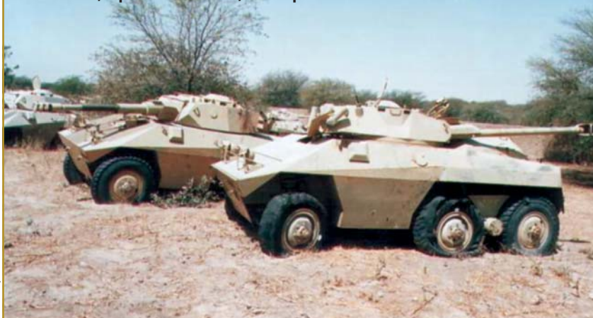
Os dois modelos de EE-9 Cascavel vendidos para a Líbia, o da frente, modelo com canhão cockerill 90mm e torre Engesa MKIII, e o de trás com torre e canhão francês de 90mm MK II, capturados no Chade, num depósito em 2002.
