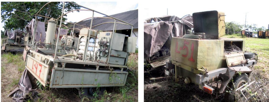
Os dois modelos de reboques que vieram junto com os caminhões, à esquerda estação de tratamento de água e à direita gerador diesel. (Crédito das fotos: Leiloeiro Público Oficial do Estado)
