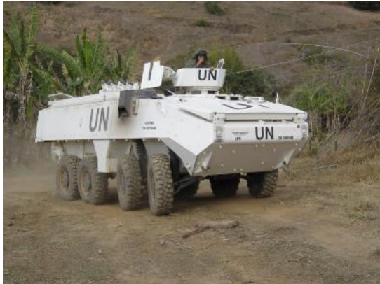
Detalhe do giro das rodas frontais, eixos desengatáveis e proteção blindada antiminas (Fotos: autor)
