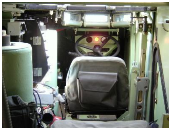
Detalhe da porta traseira hidráulica e compartimento do motorista. Notar os três periscópios de visão logo acima do volante. (Fotos: autor)
