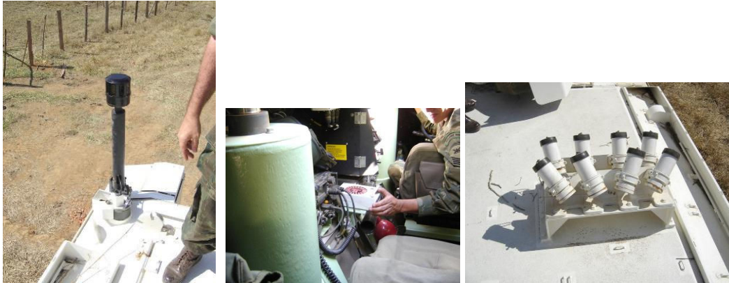
Da esquerda para a direita: o sensor, o receptor e os lançadores de granadas fumígenas. (Fotos: autor)
