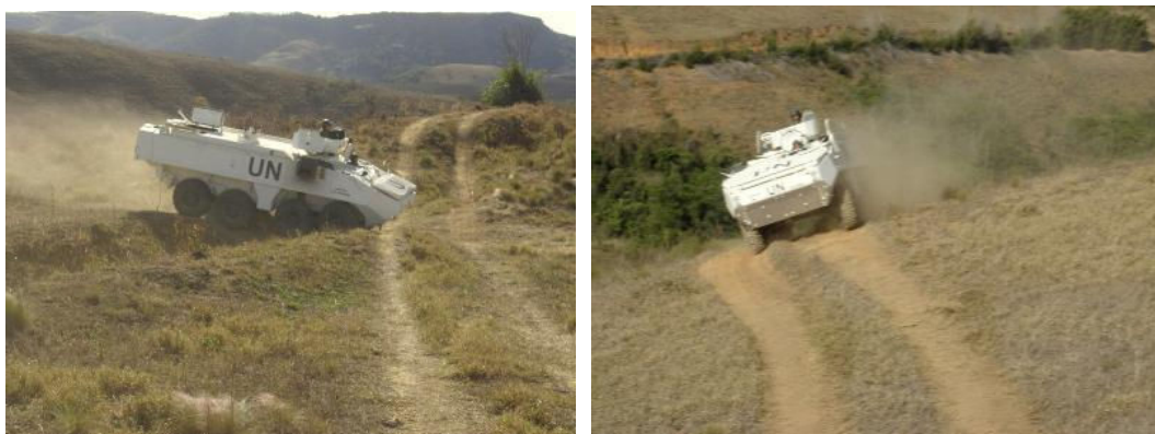
Desempenho em terreno montanhoso com cota de 600m, rampas de 80% e inclinação de 30% em terreno acidentado e extremamente seco. (Fotos: autor)
