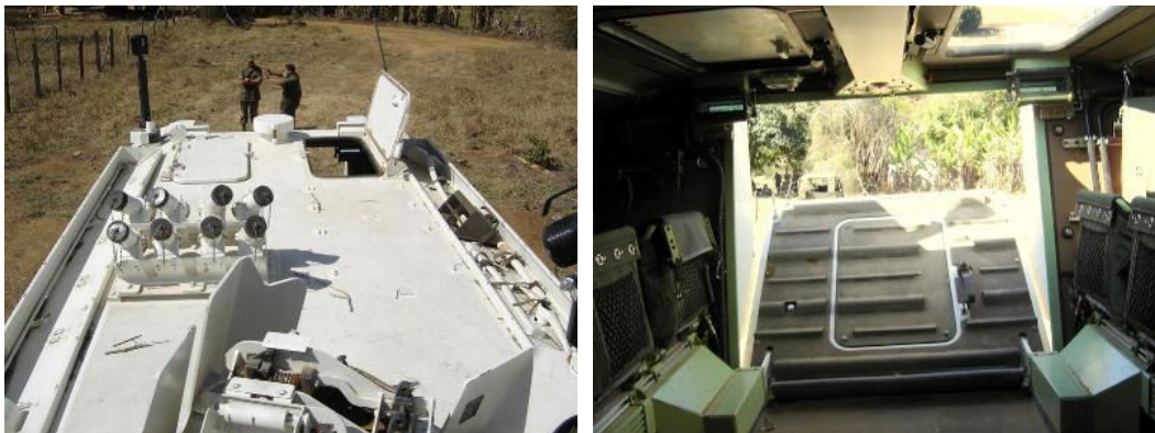
Detalhe das duas escotilhas no teto do carro na parte traseira, e ferramentas de sapador e rampa hidráulica para embarque e desembarque das tropas. (Fotos: autor)
