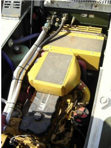
Detalhe do motor Caterpillar C-9 e o escapamento na lateral do veículo. (Fotos: autor)
