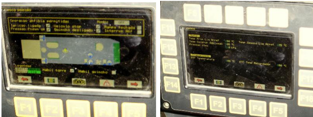
Tela do computador de bordo em português onde todo o diagnóstico do veículo pode ser feito pelo motorista. (Fotos: autor)
