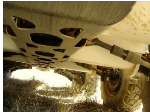
Detalhe do giro das rodas frontais, eixos desengatáveis e proteção blindada antiminas (Fotos: autor)
