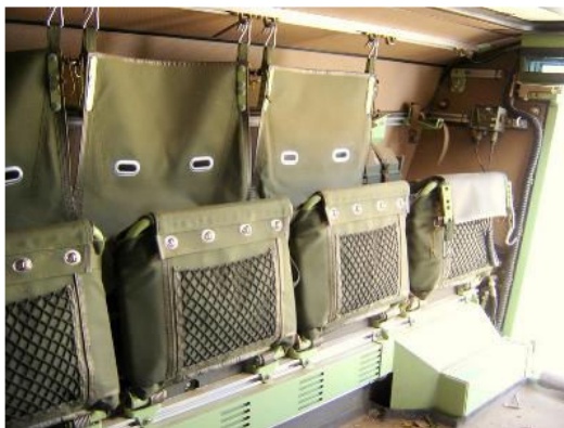
Detalhe do interior, em verde os bancos e porta trecos, em marrom forração em kevlar e detalhe da blindagem adicional na lateral traseira do veículo. Notar os parafusos de fixação e os dois tanques de combustíveis externos. (Fotos: autor)
