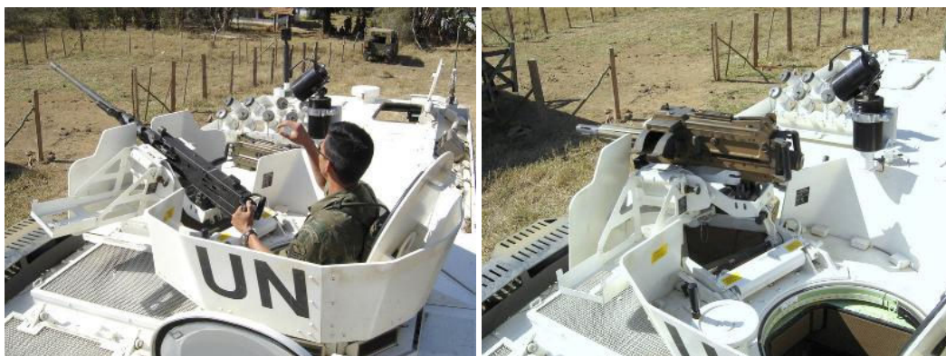
A torreta com dois tipos de armamento, uma .50 e um lançador de granadas de 40mm. Notar a parte escura abaixo do lançador, a bacia de lona para coletar cartuchos deflagrados. (Fotos: autor)
